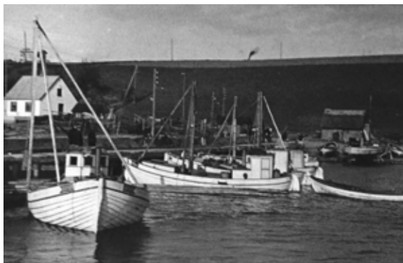
Kuttere med påmonteret ramslag til sætning af bundgarnspæle.
